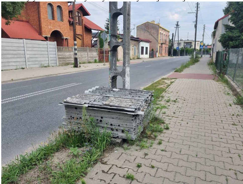
Fotografia 11. Płyty azbestowe przy ulicy Taraszczyńskiej w Sulejowie
